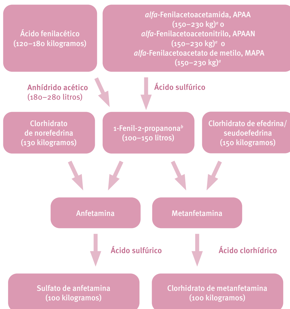
Figura II. Fabricación ilícita de anfetamina y metanfetamina: sustancias fiscalizadas y cantidades aproximadas necesarias para la fabricación ilícita de 100 kilogramos de sulfato de anfetamina y clorhidrato de metanfetamina
